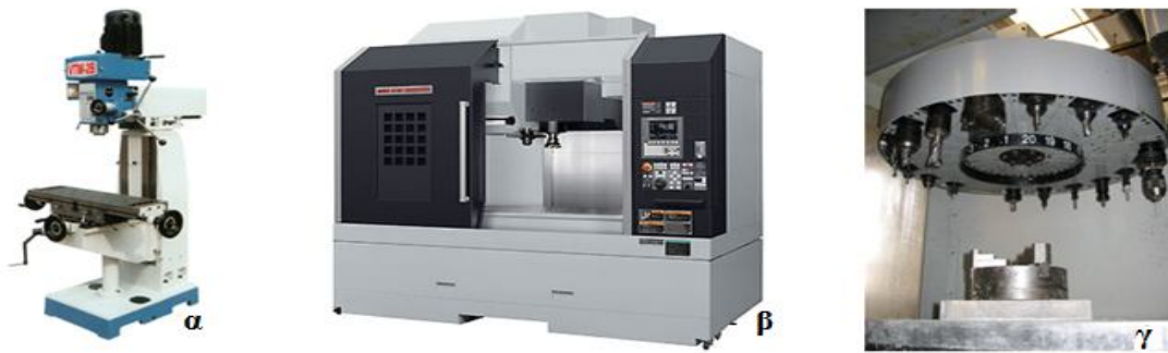
Σχήμα 1.6: (α) Σύγχρονο χειροκίνητο δρέπανο, (β) κάθετο κέντρο κατεργασίας CNC, (γ) αυτόματος τροφοδότης κοπτικών εργαλείων.
