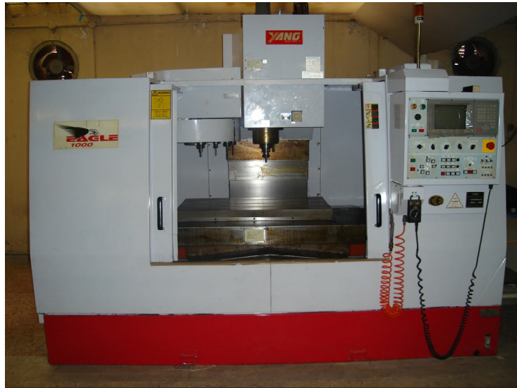
Σχήμα 3.1: Κάθετο κέντρο κατεργασίας Yang Eagle SMV – 1000.
