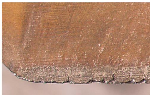
Σχήμα 1.14: Απεικόνιση φθοράς λόγω αποκολλήσεων.
