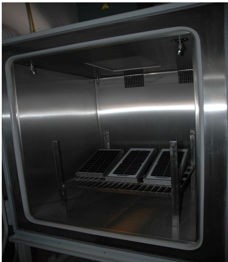
Σχήμα 3.19 Φ/Β πλαίσια εντός του θερμοθαλάμου
