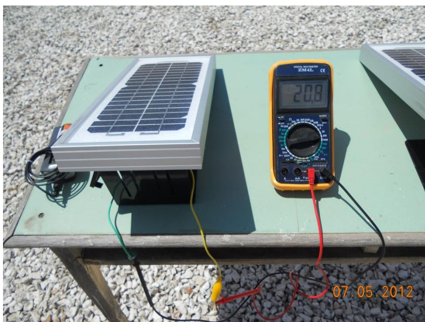
Σχήμα 3.11 Μέτρηση τάσης ανοιχτού κυκλώματος Φ/Β πλαισίου
