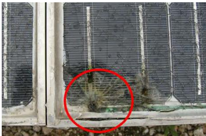
Σχήμα 1.1 Αστοχία λόγω θραύσης του εμπρόσθιου στρώματος ενός Φ/Β πλαισίου [5]
