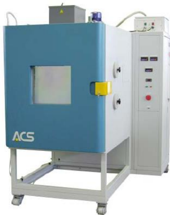
Σχήμα 3.15 Ο ημιβιομηχανικός θερμοθάλαμος ελέγχου κλιματικών δοκιμών, τεχνητής επιταχυνόμενης γήρανσης, Angelantoni TM GTS 600
