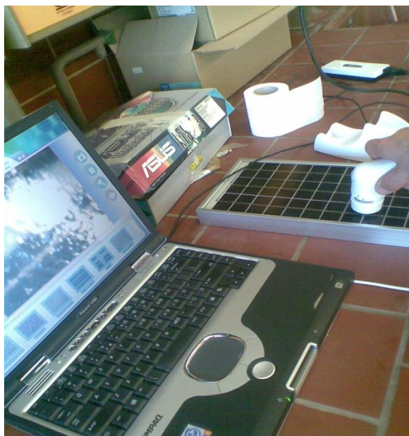
Σχήμα 3.7 Έλεγχος πιθανής βλάβης σε Φ/Β πλαίσιο με χρήση οπτικής μικροσκοπίας
