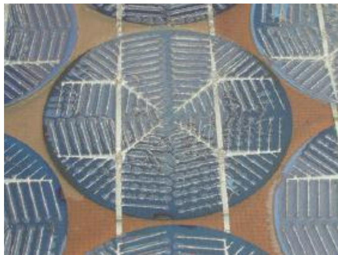
Σχήμα 1.26 Στοιχείο με έντονο το φαινόμενο της αποκόλλησης της EVA [8]
