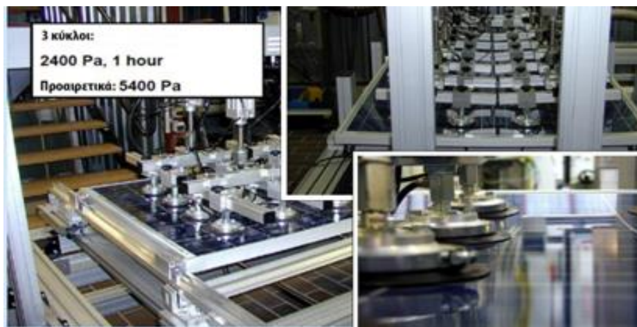
Σχήμα 2.12 Διάταξη και διαδικασία δοκιμής μηχανικής καταπόνησης [9]
