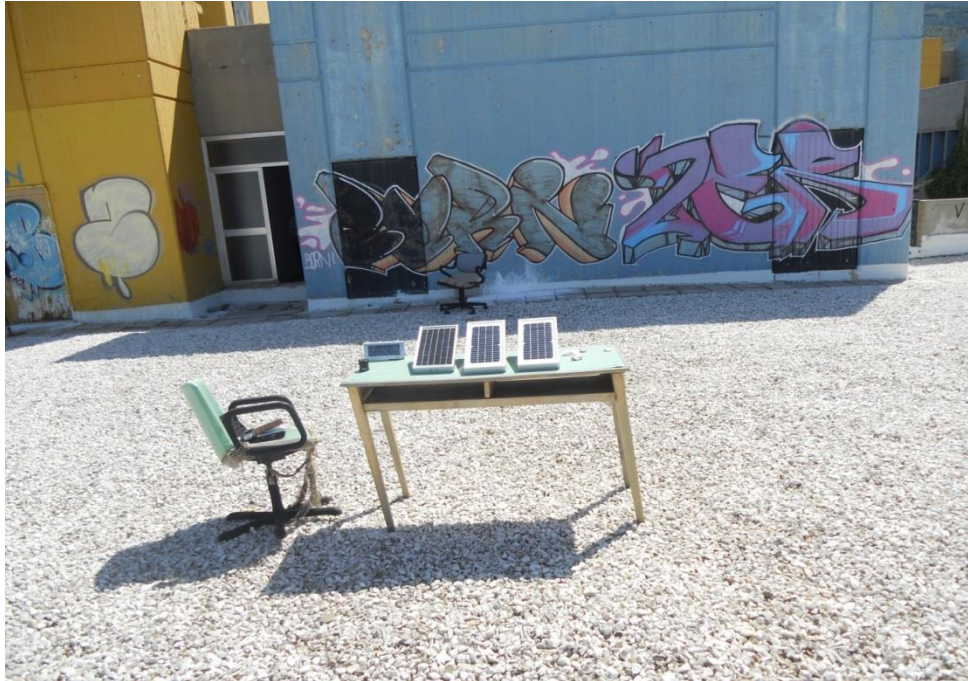
Σχήμα 4.1 Η τοποθέτηση των Φ/Β για τη λήψη των θερμογραφημάτων και των ηλεκτρικών μετρήσεων.
