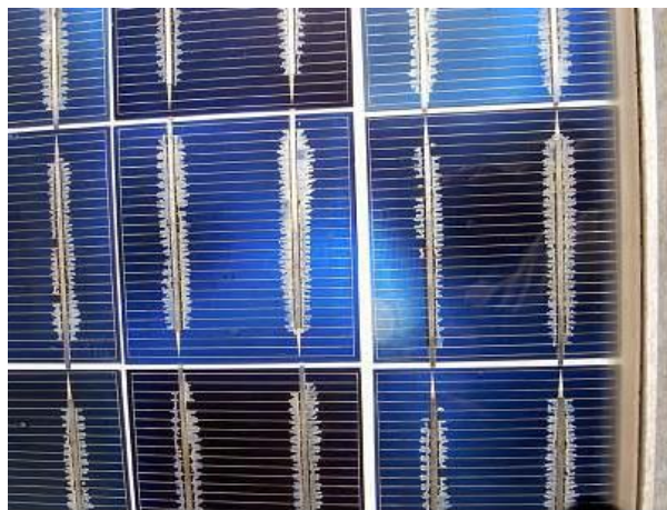
Σχήμα 1.17 Φ/Β πλαίσιο με εκτεταμένη αποκόλληση του στρώματος EVA [5]
