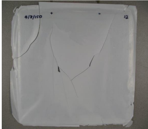
Σχήμα 1.5 Σπασμένο PET λόγω υψηλής θερμοκρασίας [10]
