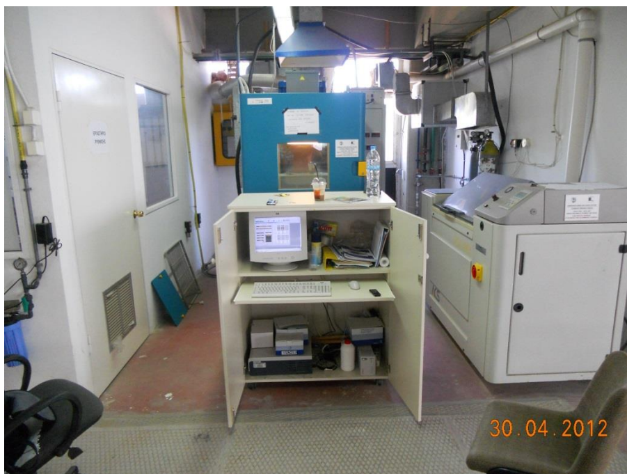
Σχήμα 3.16 Έλεγχος ημιβιομηχανικού θερμοθαλάμου από υπολογιστή στον οποίο είναι εγκατεστημένο το λογισμικό Winkratos
