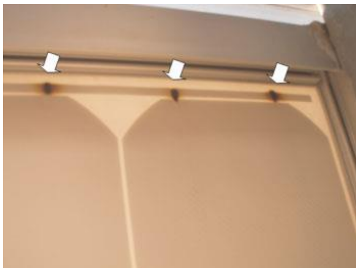
Σχήμα 1.36 Εμφάνιση θερμών κηλίδων στους δεσμούς συγκολλήσεων του πίνακα ηλιακών κυψελών [19]
