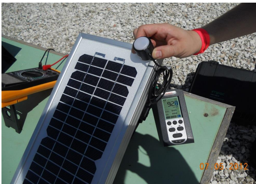
Σχήμα 3.14 Μέτρηση προσπίπτουσας ακτινοβολίας στην επιφάνεια του Φ/Β πλαισίου με την χρήση πυρανομέτρου
