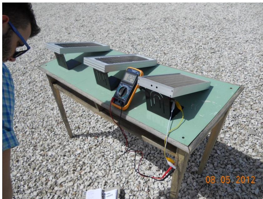
Σχήμα 3.12 Μέτρηση ρεύματος βραχυκύκλωσης Φ/Β πλαισίου
