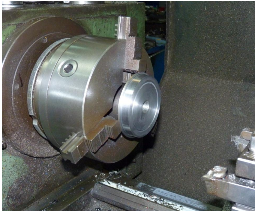
Σχήμα 4.16: Τόρνευση κινούμενου οδοντωτού τροχού
