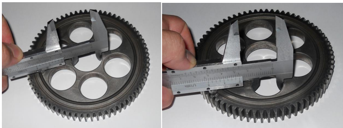
Σχήμα 2.8: Μέτρηση της διαμέτρου της κεντρικής οπής και των περιμετρικών οπών
