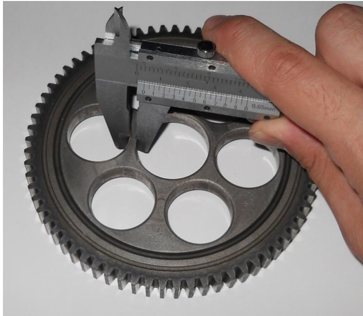
Σχήμα 2.9: Μέτρηση της απόστασης της περιμέτρου της κεντρικής οπής από την περίμετρο των άλλων οπών
