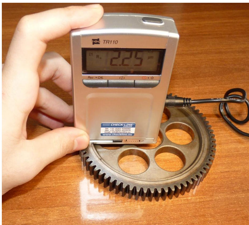
Σχήμα 2.72: Μέτρηση τραχύτητας της επιφάνειας των οδόντων κινούμενου τροχού
