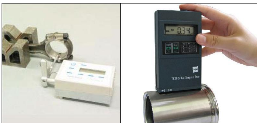
Σχήμα 2.66: Τραχύμετρα (α) εργαστηριακό και (β) εργοταξιακό [6]
