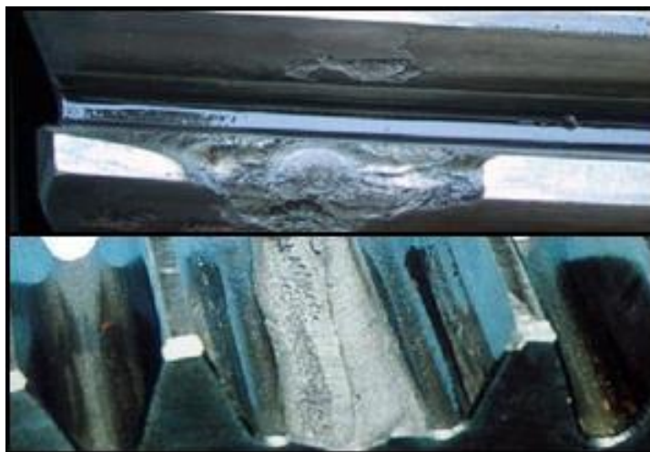
Σχήμα 3.1: Πάνω - δημιουργία «σκαψιμάτων» ( pittings ) σε οδόντες, κάτω – θραύση οδόντα [7]
