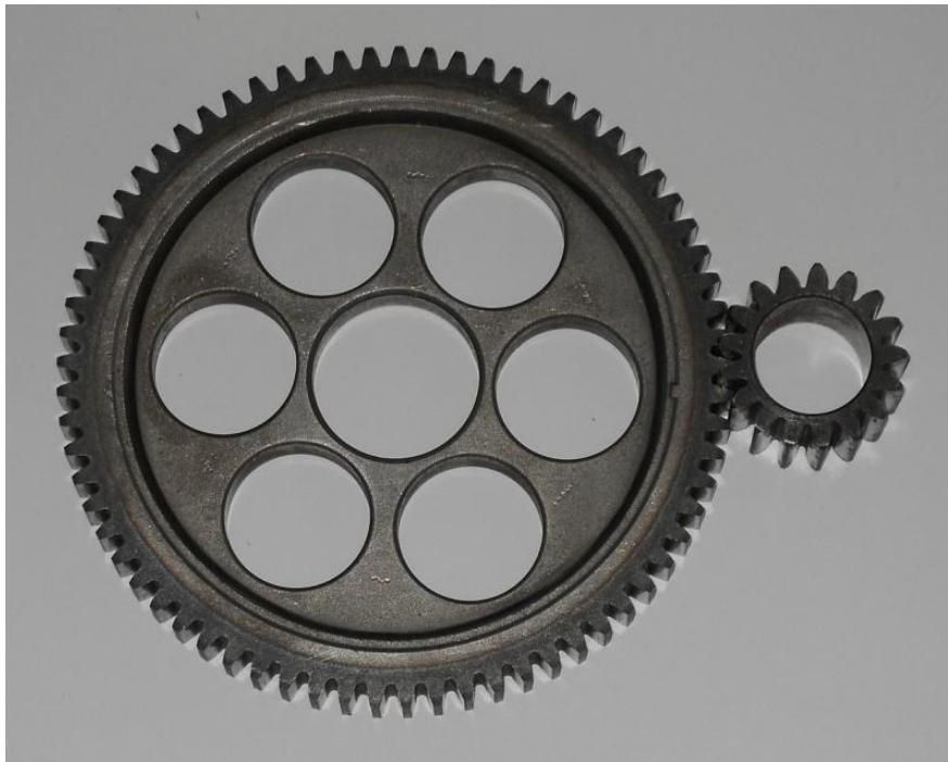
Σχήμα 1.19: Το ζεύγος οδοντωτών τροχών προς μελέτη (μονοβάθμιος μειωτήρας)
