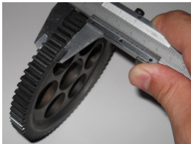
Σχήμα 2.6: Μέτρηση του πλάτους του οδόντα
