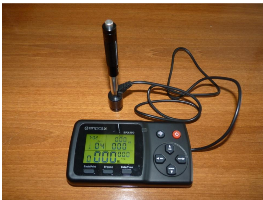
Σχήμα 3.11: Το φορητό σκληρόμετρο ENPQIX EPX300
