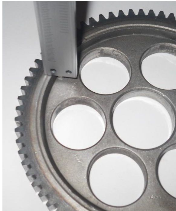
Σχήμα 2.12: Μέτρηση του βάθους της μεγάλης εσοχής
