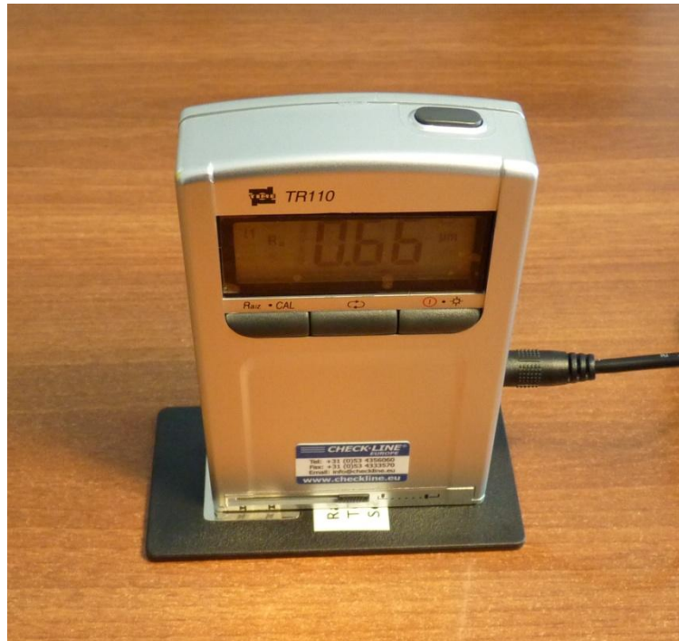
Σχήμα 2.70: Το ηλεκτρομηχανικό τραχύμετρο που χρησιμοποιήθηκε
