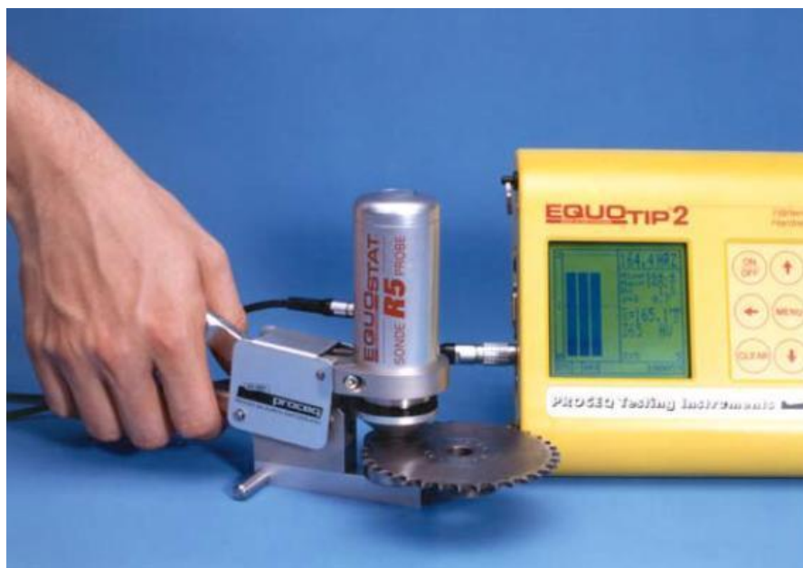
Σχήμα 3.10: Σκληρόμετρο EQUOTIP με χρήση του αισθητήρα EQUOSTAT [9]
