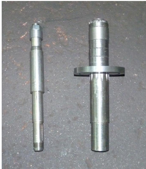
Σχήμα 4.17: Οι κύλινδροι περασμένοι σε άξονες για να τοποθετηθούν στον γραναζοκόπτη
