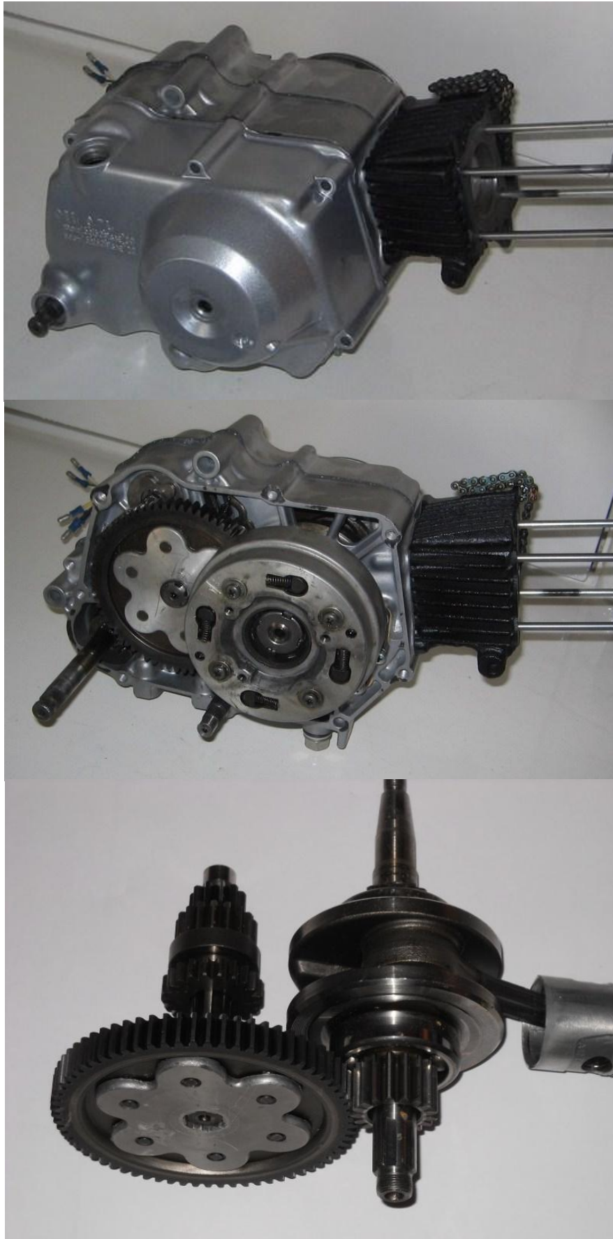
Σχήμα 1.18: Εικόνες από την διαδικασία αποσυναρμολόγησης του κινητήρα
