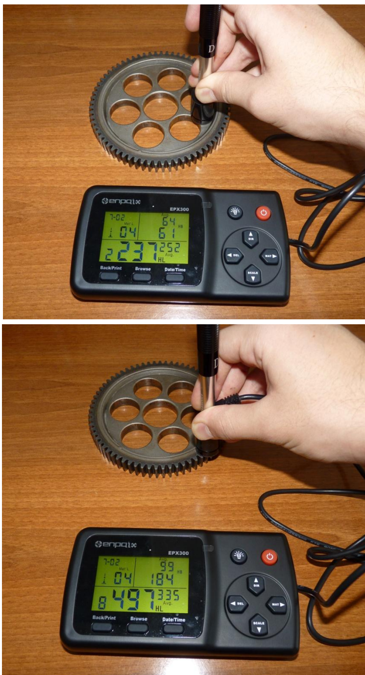
Σχήμα 3.13: Μέτρηση σκληρότητας: πάνω – σώματος, κάτω – οδόντων κινούμενου τροχού
