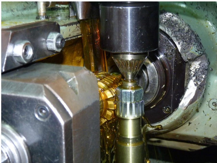
Σχήμα 4.18: Κοπή οδόντων κινητήριου τροχού με γραναζοκόπτη τύπου Hob
