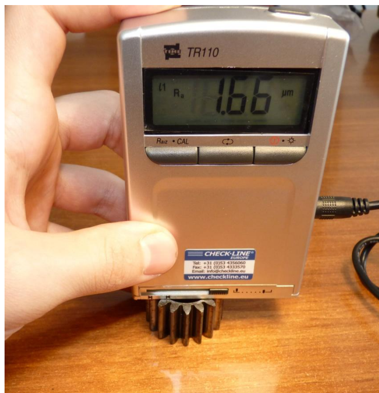
Σχήμα 2.71: Μέτρηση τραχύτητας της επιφάνειας των οδόντων κινητήριου τροχού
