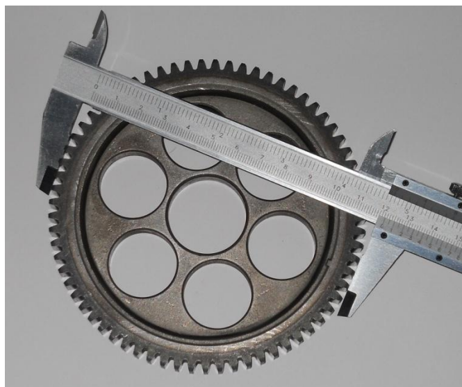
Σχήμα 2.7: Μέτρηση διαμέτρου κύκλου κεφαλής
