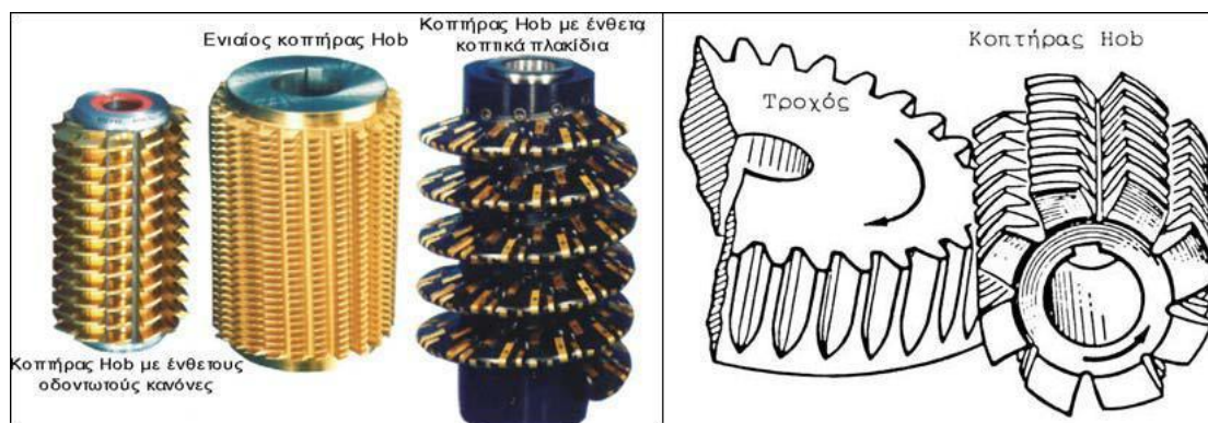
Σχήμα 4.4: Κοπτήρες Hob και διαδικασία κοπής [2]
