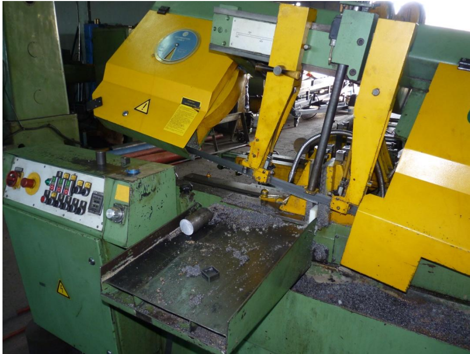
Σχήμα 4.13: Κοπή αρχικών κυλίνδρων με πριονοκορδέλα
