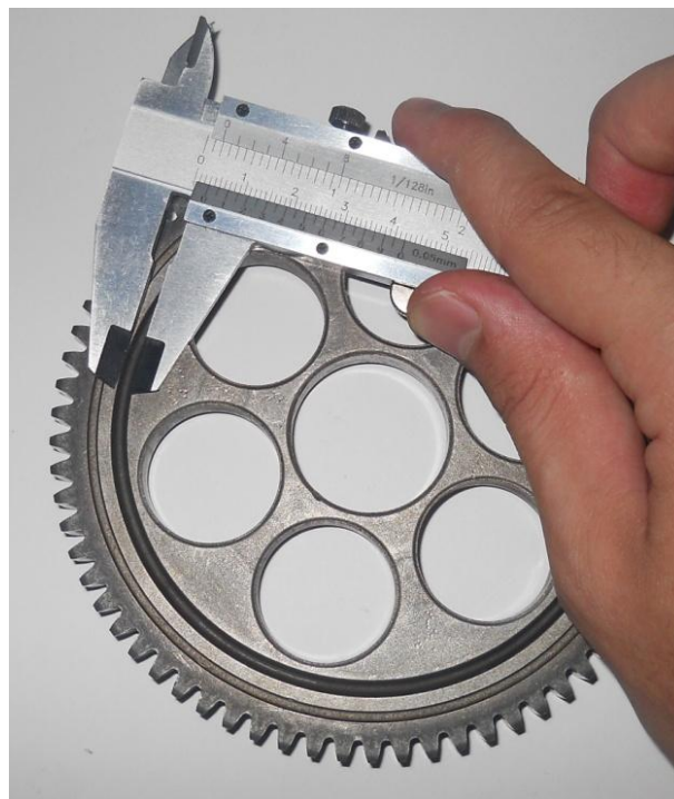
Σχήμα 2.14: Μέτρηση της διαμέτρου της ημικύκλιας εσοχής
