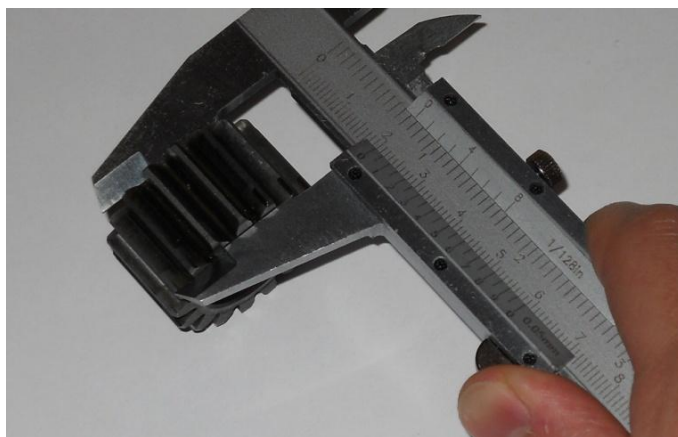
Σχήμα 2.1: Μέτρηση του πλάτους του οδόντα
