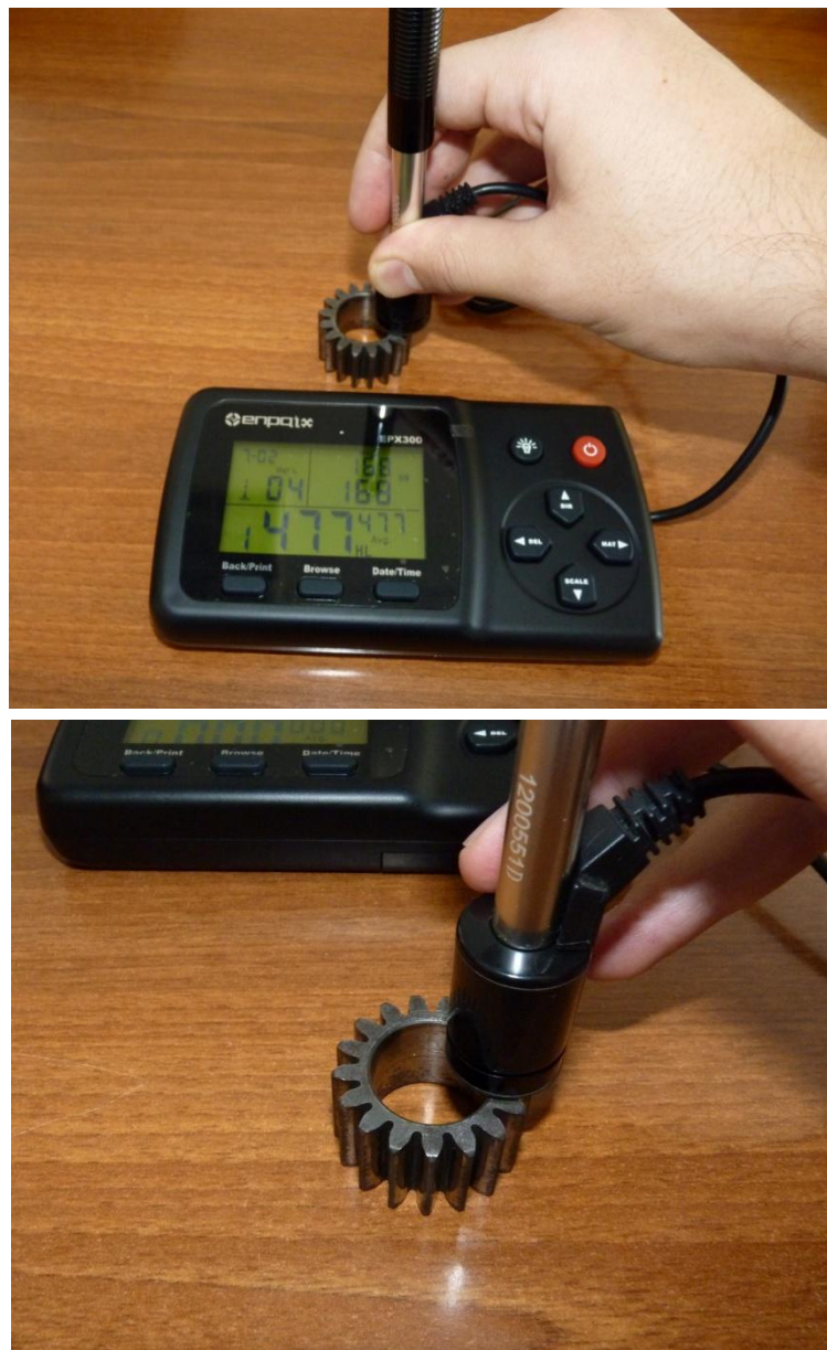
Σχήμα 3.12: Μέτρηση σκληρότητας κινητήριου τροχού
