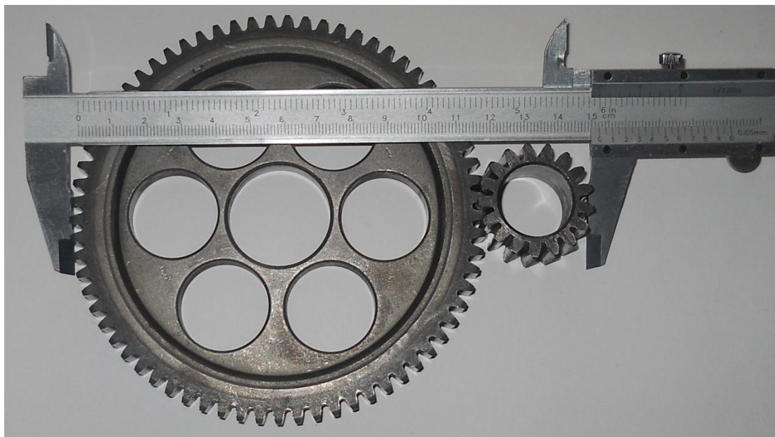
Σχήμα 2.16: Μέτρηση της μέγιστης απόστασης των κύκλων κεφαλής των τροχών
