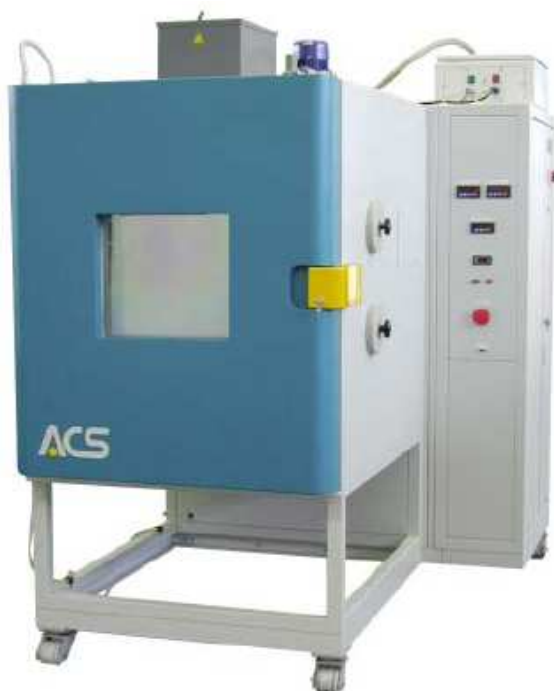
Σχήμα 6.17. Ο ημιβιομηχανικός θερμοθάλαμος ελέγχου κλιματικών δοκιμών, τεχνητής επιταχυνόμενης γήρανσης, Angelantoni™ GTS600.
