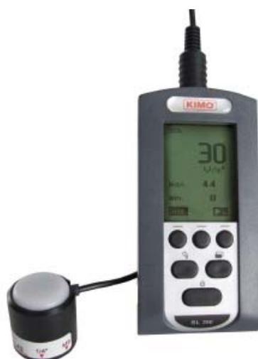
Σχήμα 5.14. Το πυρανόμετρο KIMO™ SL 200.
