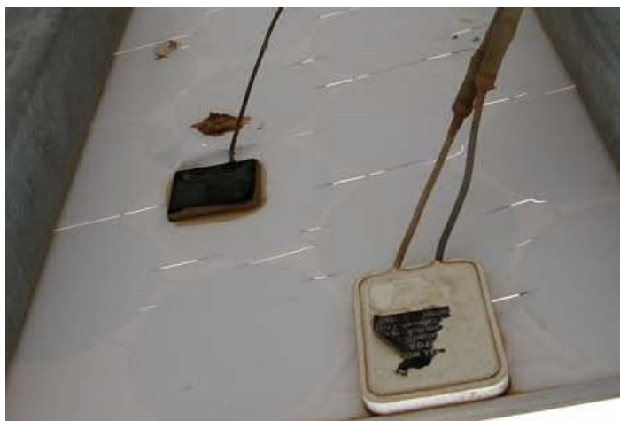
Σχήμα 3.2. Υπόστρωμα Φ/Β πλαισίου με εκτεταμένες ρωγμές [4].
