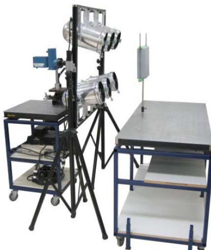
Σχήμα 4.17. Τυπική διάταξη ενεργητικής lock-in θερμογραφίας [1].
