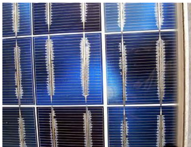
Σχήμα 3.10. Φ/Β πλαίσιο με εκτεταμένη αποκόλληση του στρώματος EVA [4].
