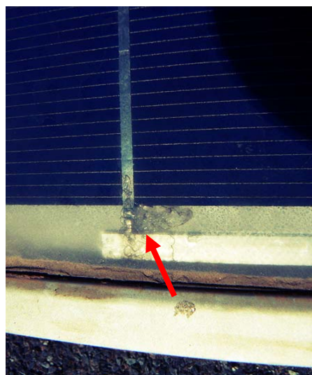
Σχήμα 5.26. Φ/Β πλαίσια της PV-3 με βλάβη: α. θραύσης κυψέλης και β. φυσαλίδας στο στρώμα ενθυλάκωσης (EVA).
