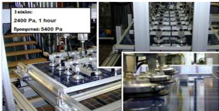
Σχήμα 6.11. Διάταξη και διαδικασία δοκιμής μηχανικής καταπόνησης [24].
