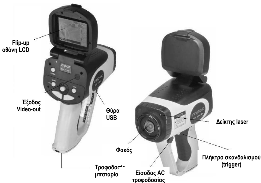
Σχήμα 4.13. Βασικά εξωτερικά χαρακτηριστικά μιας τυπικής θερμοκάμερας [1].
