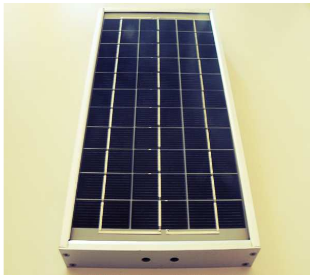
Σχήμα 6.13. Το Φ/Β πλαίσιο τύπου Siemens™ SM6 (PV-1).
