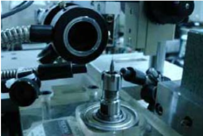
Σχήμα 1.6. Εφαρμογή συστήματος (αριστερά) και εικόνες (δεξιά) μηχανικής όρασης για CM σε κοπτικά εργαλεία διάτρησης [37].
