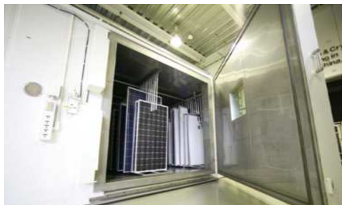
Σχήμα 6.5. Ένας τυπικός θερμοθάλαμος κλιματικών δοκιμών [24].
