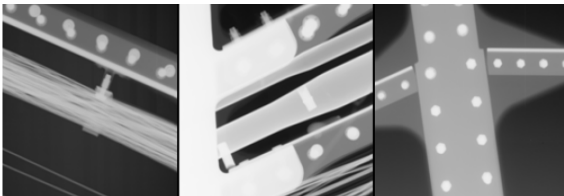
Σχήμα 1.10. Εφαρμογή ραδιογραφίας για την ανίχνευση μικρορωγμών σε φτερά αεροπλάνου.
