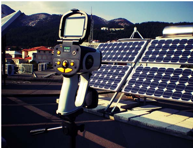
Σχήμα 5.15. Ενδεικτικό παράδειγμα μιας διαδικασίας υπέρυθρης ραδιομέτρησης, για τα Φ/Β πλαίσια της συστοιχίας PV-1.
