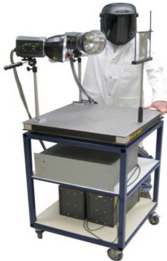
Σχήμα 4.16. Τυπική διάταξη ενεργητικής θερμογραφίας στιγμιαίων θερμικών παλμών [1].
