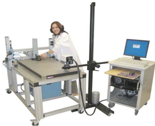
Σχήμα 4.19. Τυπική διάταξη θερμογραφίας δονήσεων/υπερήχων [1].
