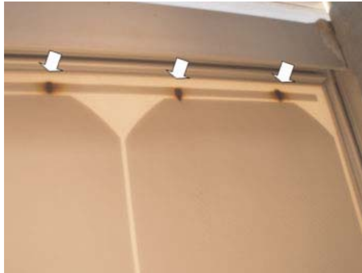
Σχήμα 3.23. Εμφάνιση θερμών κηλίδων στους δεσμούς συγκολλήσεων του πίνακα ηλιακών κυψελών [25].
