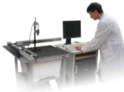
Σχήμα 4.18. Τυπική διάταξη επαγωγικής θερμογραφίας [1].
