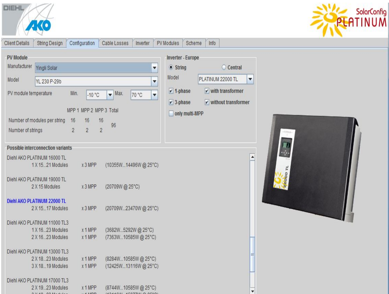
Εικόνα 2.42: Διαμόρφωση εγκατάστασης και πιθανές παραλλαγές διασύνδεσης
