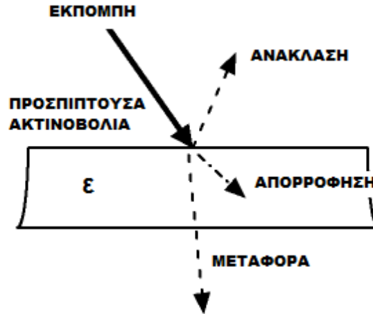
Σχήμα 1.5: Αλληλεπίδραση μια προσπίπτουσας θερμικής ακτινοβολίας Q με τυχαία επιφάνεια υλικού [1,2].
